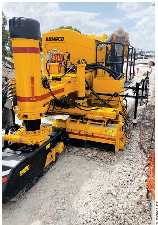
Le mécanisme de pivotement à capteurs rotatifs en option sur le châssis avant permet un déplacement indépendant.
