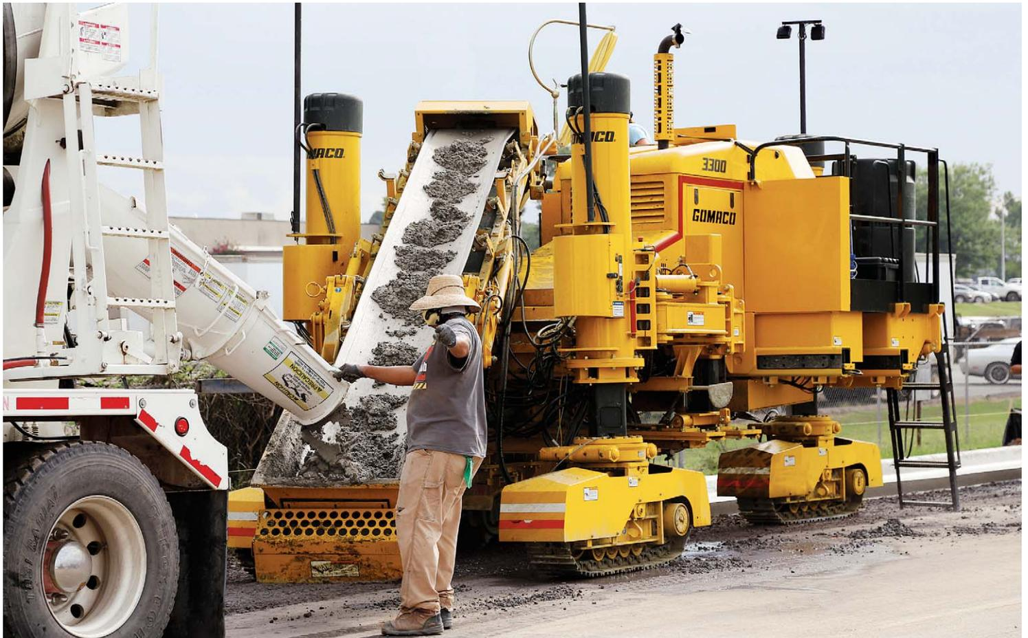
Un transporteur repliable de 6,1 mètres est aussi disponible sur la GOMACO 3300 pour charger la trémie. Il peut être positionné pour une utilisation à droite ou à gauche de la machine. Il se replie pour réduire la longueur de transport de la bétonnière.
