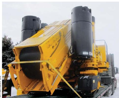
Le transporteur repliable réduit les dimensions de transport de la GOMACO 3300.
