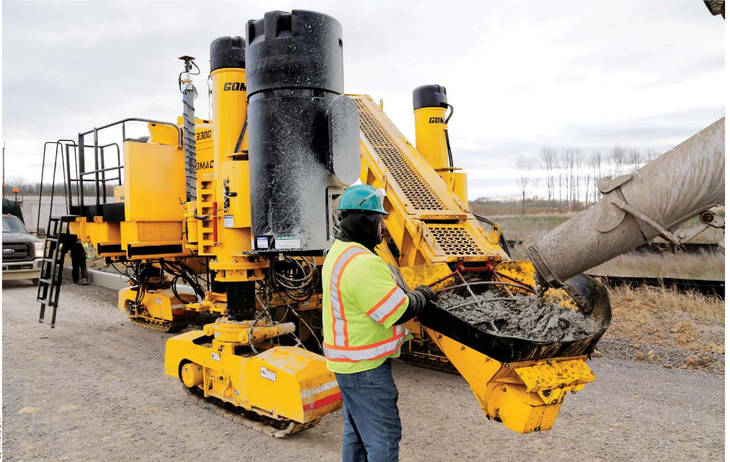
La vis de chargement de la 3300 est équipée d'un système à vibrations pour empêcher l'accumulation de béton sur la protection située à l'extrémité de la trémie. Les protections de la vis sont montées sur charnières pour permettre le nettoyage.
