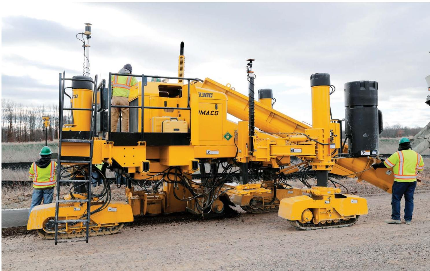
La GOMACO 3300 est conçue pour effectuer des coulages à droite comme à gauche. La plate-forme de l'opérateur en forme de U et le pupitre de commande glissant donnent une visibilité et une maîtrise optimales pour travailler dans un sens ou dans l'autre.
