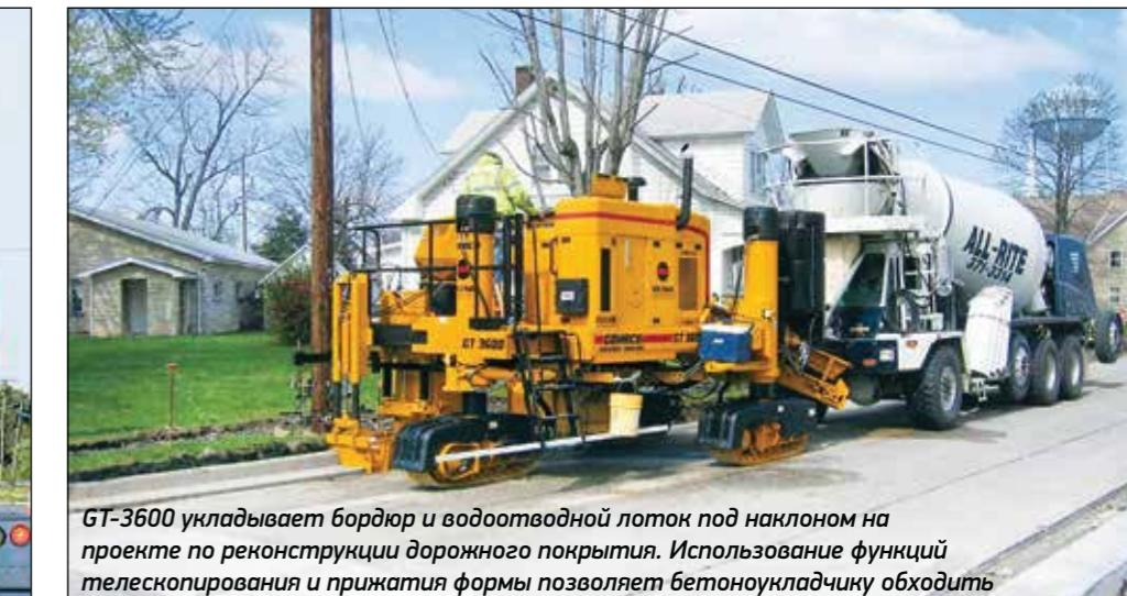
Система позиционирования всех гусеничных тележек (ATP) обеспечивает простоту настройки для укладки в скользящей форме пешеходных дорожек. Курс и высота бетоноукладчика определяются с учётом существующего бордюра
