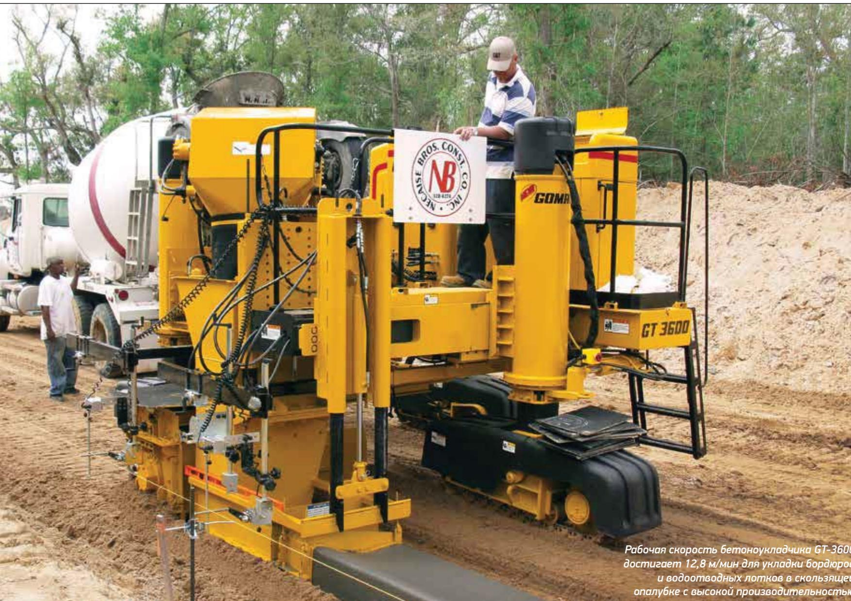
Рабочая скорость бетоноукладчика GT-3600 достигает 12,8 м/мин для укладки бордеров и водоотводных лотков в скользящей опалубке с высокой производительностью
