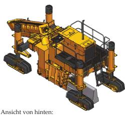
Ansicht von hinten: Unterbaute, linksseitige Betonierfähigkeit – maximale Hochbarrierenhöhe von 1000 mm. Schalteile können auch für rechtsseitiges Betonieren unterbaut werden.
