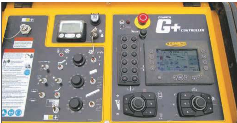
G+ подключается к системе нивелирования Leica Geosystems 3D для точного бесструнного профилирования основания с использованием GOMACO 9500
