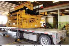
El accesorio IDBI tiene estabilizadores que pueden soportar la totalidad de su peso para facilitar su instalación y retiro de la pavimentadora, o para levantarlo para su transporte en un remolque.
