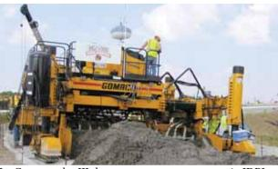
La Commander III de cuatro orugas con accesorio IDBI puede pavimentar anchos de hasta 4,9 metros.
