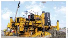
Una Commander III con encofrados deslizantes de accesorio IDBI de 3,7 metros de ancho.
