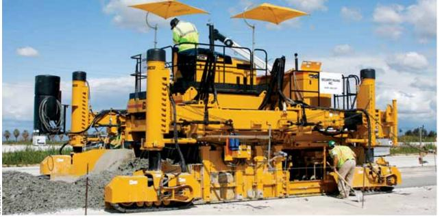
La Commander III de cuatro orugas, con accesorio IDBI, vierte encofrados deslizantes en un carril nuevo de un proyecto de carretera.
