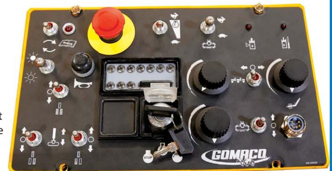
Les commandes de déplacement, de pente, des vibreurs et de la vis d'alimentation sont situées sur la poignée pour un accès facile.
