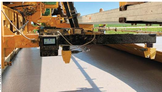
Les écrans LCD fournissent des diagnostics numériques à l'emplacement du capteur ou peuvent envoyer des relevés au système Navigator en option fixé sur le côté de la bétonnière.
