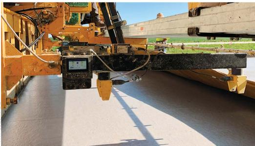
Die LCD-Bildschirme liefern digitale Diagnosen am Sensorstandort oder können die Messwerte an das optionale Navigator-System senden, das an der Seite des Fertigers.
