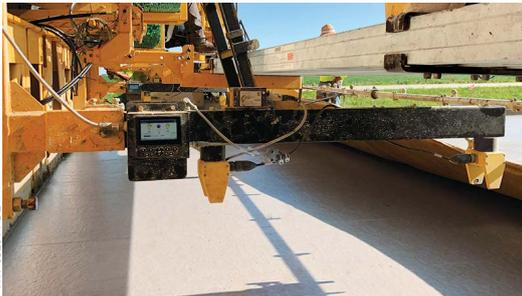
Gli schermi LCD forniscono la diagnostica digitale nella posizione del sensore o possono inviare le letture al sistema Navigator opzionale attaccato sul lato della finitrice.
