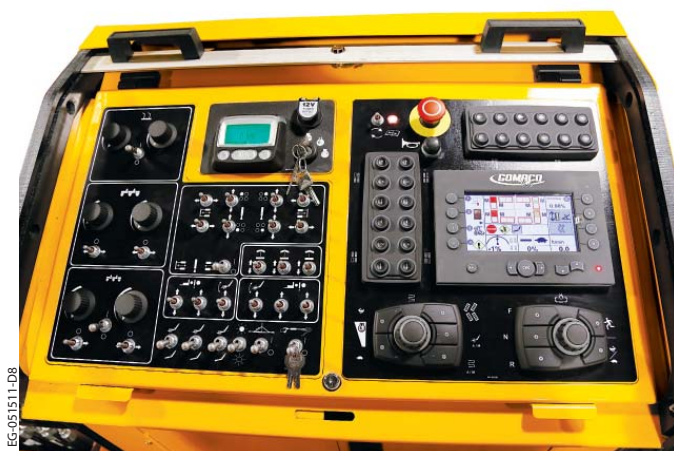
EG-051511-D8 GOMACO GHP-2800: Czterogłosienicowa układarka betonu wyposażona w system G+.
