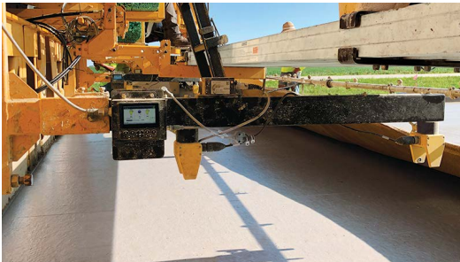
Las pantallas LCD proporcionan diagnósticos digitales en la ubicación del sensor o pueden enviar lecturas al sistema opcional Navigator, conectado a un lado de la pavimentadora.
