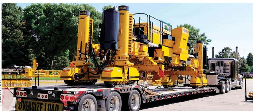
En mode transport, la bétonnière GP3 à quatre chenilles présente une longueur minimum de 10,15 mètres, une largeur minimum de 2,8 mètres et une hauteur minimum de 3,14 mètres.
