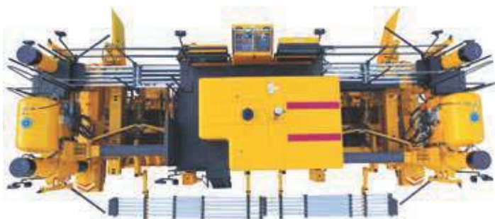
Двухгусеничный бетоноукладчик GP3 со скользящей опалубкой; вид сверху.
