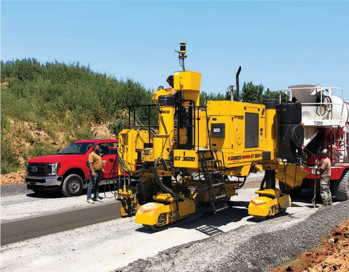
Der Xtreme GT-3600 fertigt Bordkanten und Rinnsteine mithilfe der 3D-Maschinenführung. Diese extreme Lenkfähigkeit in Kombination mit der sensorgesteuerten Lenkbarkeit und Platzierbarkeit aller Raupen machen den Xtreme GT-3600 zu einem schwer zu übertreffenden, intelligenten Gleitschalungsfertiger.
