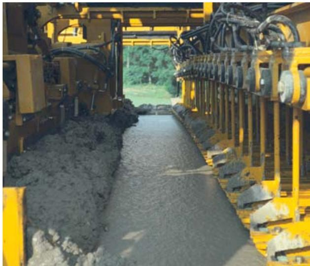
Трамбующий механизм, уникальная вибрирующая гладилка, плита для укладки и компоненты из нержавеющей стали устраняют неровности покрытия.
