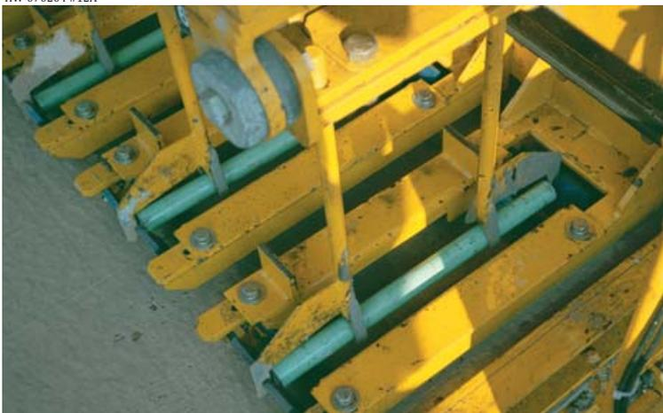
Вилочные захваты находятся в режиме ожидания в точке погружения, ожидая сигнал с компьютера IDBI. Система IDBI нового поколения оснащается регулируемыми поддонами со стержнями и вилочными захватами погружения. Это позволяет корректировать расстояние между центрами стержней в соответствии с техническими условиями проекта (см. стр. 6).
