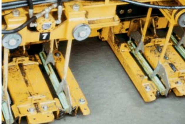
При проведении многих видов работ требуется погружение в покрытие как арматурных стержней, так и поперечной арматуры. Компьютер системы IDBI управляет погружением арматуры всех типов (передняя, задняя и IDBI). Пространство на лотке, представленное на рисунке выше, соответствует пропущенному стержню продольного соединения.
