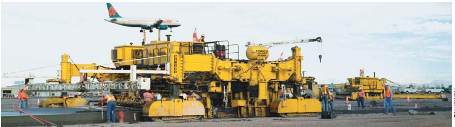
Этот четырехгусеничный бетоноукладчик GP-4000 со скользящими формами, оборудованный запатентованной компанией GOMACO системой автоматического погружения арматурных стержней (IDBI), соответствует всем техническим условиям аэропорта Sky Harbor в Финиксе, Аризона. Высокая производительность при укладке взлетно-посадочной полосы и бетонированных площадок при укладке бетонной смеси с помощью скользящих форм глубиной до 483 мм и шириной 15,24 м.
