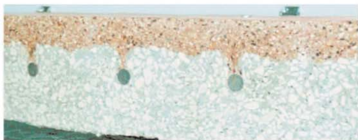
插入传力杆的双层滑模摊铺板块的横向截面图
