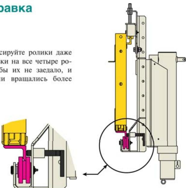
Оправка в сборе для увеличения расширения ручным или механическим способом. Железные уголки для улучшения контакта роликов и более плавного движения. Все новые оправки имеют встроенную систему самоблокировки для фиксации домкрата в любом месте вдоль рельса и предназначены для лучшего распределения веса. Обеспечивается легкая регулировка роликов.
