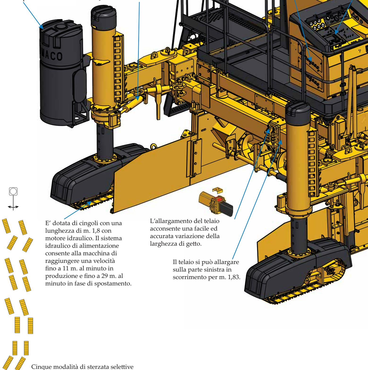
E' dotata di cingoli con una lunghezza di m. 1,8 con motore idraulico. Il sistema idraulico di alimentazione consente alla macchina di raggiungere una velocità fino a 11 m. al minuto in produzione e fino a 29 m. al minuto in fase di spostamento.
