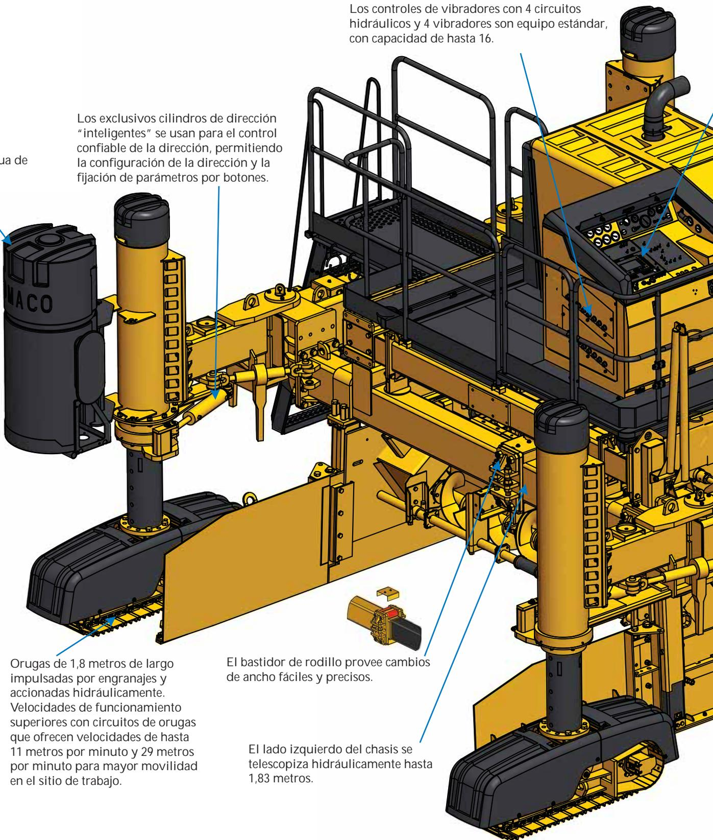
Orugas de 1,8 metros de largo impulsadas por engranajes y accionadas hidráulicamente. Velocidades de funcionamiento superiores con circuitos de orugas que ofrecen velocidades de hasta 11 metros por minuto y 29 metros por minuto para mayor movilidad en el sitio de trabajo.
