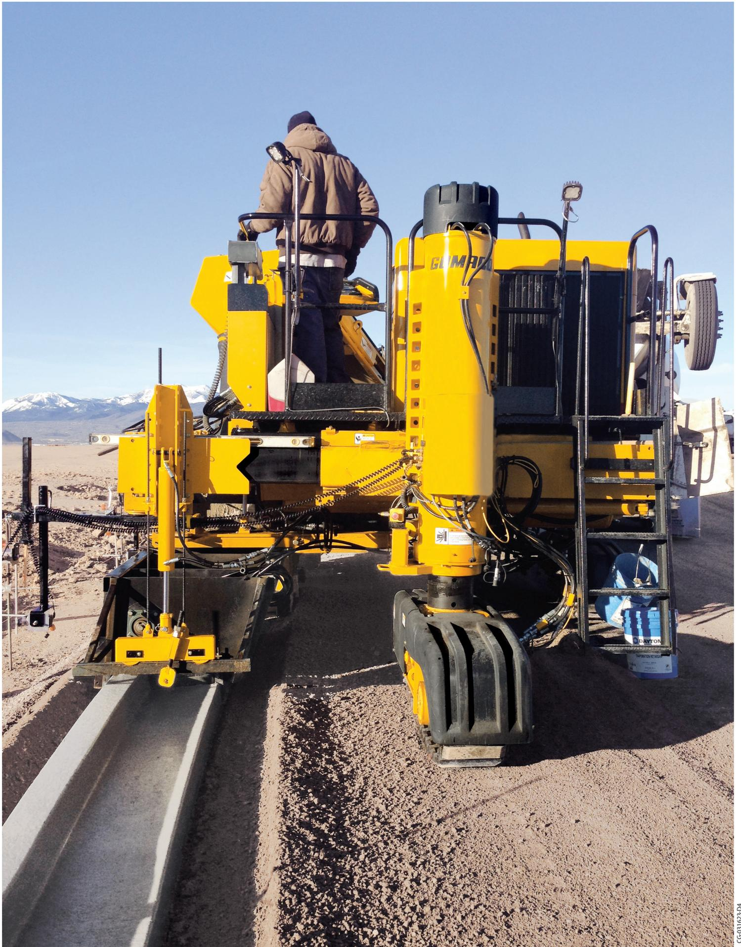
Der Commander III von GOMACO verfügt an jedem Stützbein über eine GBox. Die GBox bietet einen neuen Anbringungsort für Slave-Steuerung und Proportionalventile, verringert den Bedarf an Schläuchen und Kabeln, erleichtert die Wartung und Störungssuche und ist über eine horizontale Schwingtür in Bodennähe bequem zu erreichen.
