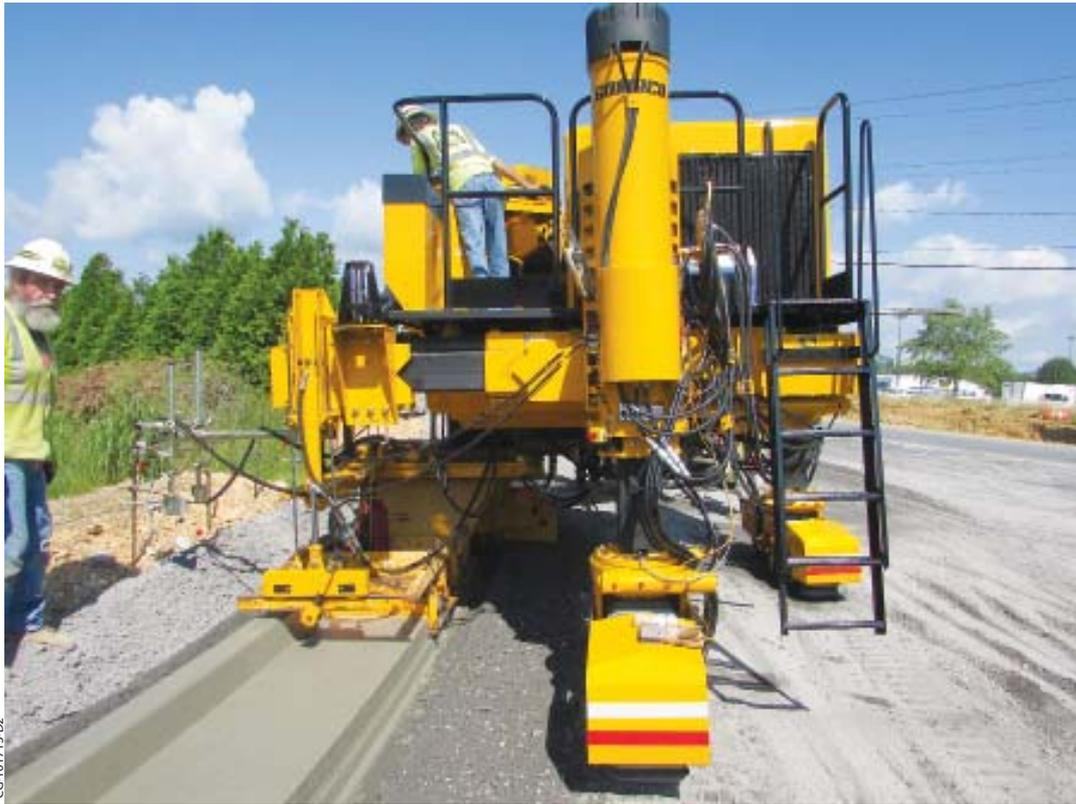
Le positionnement toutes chenilles intelligent de la GOMACO Commander IIIx fonctionne avec un vérin hydraulique intelligent sur chacune des trois colonnes. Les vérins intelligents permettent au système de commandes G+ de connaître la position des trois chenilles et peuvent effectuer des réglages de la direction selon le besoin.
