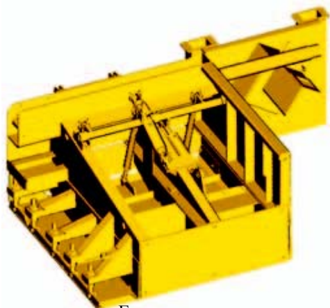
Гидравлическая система регулирования оборудования для формирования кромки.
