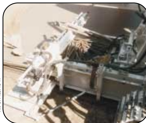
Концевая форма с пневматическим внедрением L-образных штырей.
