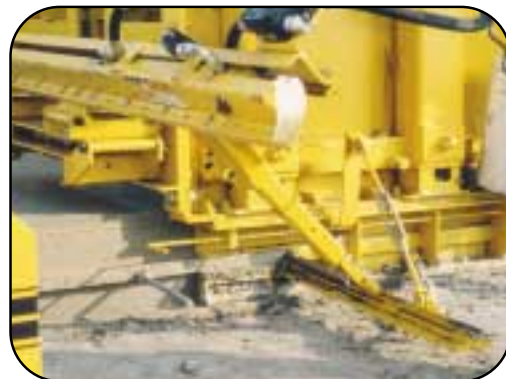
Механизм для бокового внедрения арматурных штырей.
