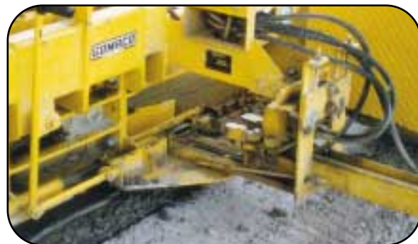
Гидравлическая система вибрационного внедрения боковых штырей.
