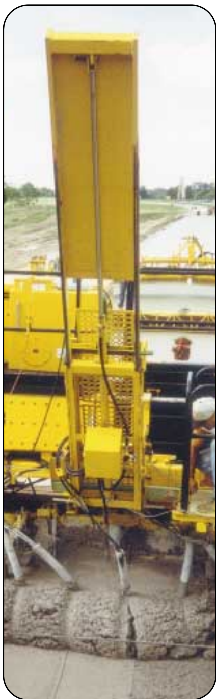
Гидравлическая система вибрационного внедрения боковых штырей.
