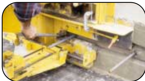
Гидравлическая система вибрационного внедрения боковых штырей.
