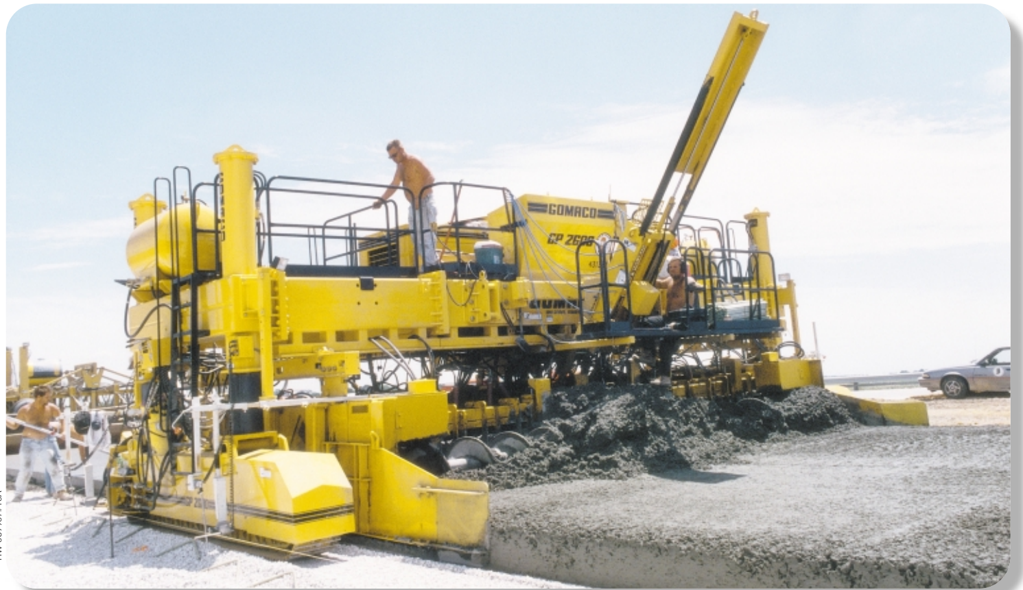
Подрядчик выбрал двухгусеничный бетоноукладчик GP-2600 корпорации GOMACO и результаты в начале строительства превзошли его самые смелые ожидания. При строительстве бетонного покрытия шириной 7,32 м и толщиной 279 мм в Индиане бетоноукладчик показал высокую производительность и прекрасные ходовые качества. На раме бетоноукладчика GP-2600 было установлено оборудование для центральной укладки арматурных штырей длиной 914 мм, обмазанных эпоксидной смолой, и механизмы для внедрения боковых штырей той же длины.
