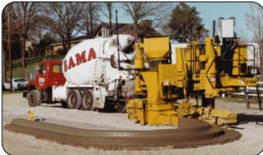
Мировая история началась в Алабаме когда GT-3600 со скользящей формой и строительным радиусом использовал систему контроля stringless.
