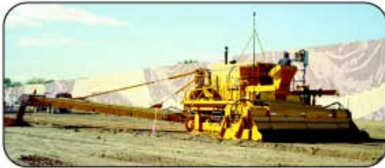
Специалисты Coffey использовали GOMACO 9500 с системой управления stringless во время строительства в Scottsdale, Arizona.
